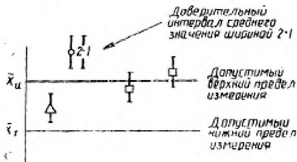
Испытание считается удовлетворительным, если доверительный интервал шириной  $2I$  находится внутри допустимых границ измерения  $x_u$  и  $x_l$
