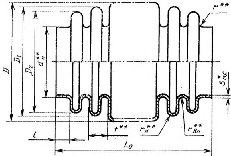
$D$  — наружный диаметр сильфона;  $D_1$  — наружный диаметр второго гофра;  $D_2$  — наружный диаметр первого гофра;  $d_n$  — наружный диаметр бортика сильфона;  $S_{м.с.}$  — толщина стенки многослойного сильфона;  $t$  — шаг гофрировки;  $l$  — длина бортика сильфона;  $L_0$  — длина сильфона;  $r$  — радиус перехода бортика сильфона в гофр;  $r_n$  — радиус выступа гофра сильфона;  $r_{вп}$  — радиус впадины гофра сильфона
