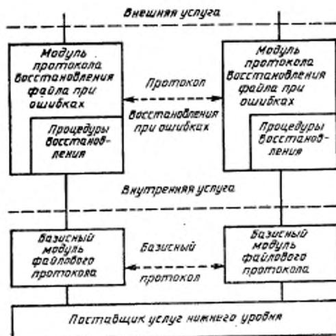
Рисунок 3 — Расширенная модель модулей файлового протокола
