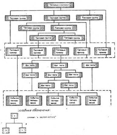
Рисунок 9 - Структура тестового комплекта
