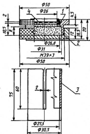
1 — резиновое профильное кольцо; 2 — дно и крышка кассеты, соединенные резьбовым соединением; 3 — вспомогательный полый цилиндр; 4 — светопрозрачное окно из плоскопараллельного стекла марки К-8 толщиной  $(2,00 \pm 0,15)$  мм по ГОСТ 3514
