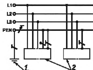
1 – заземление источника питания; 2 – открытые проводящие части
