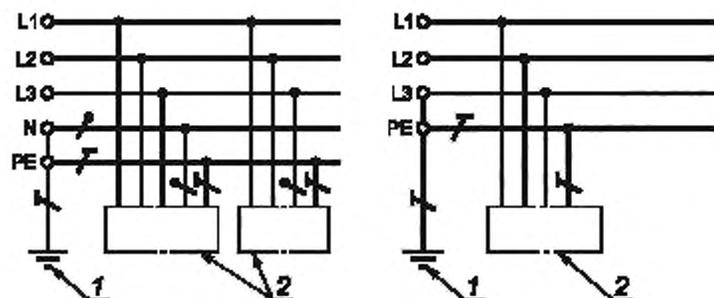
1 – заземление источника питания; 2 – открытые проводящие части
