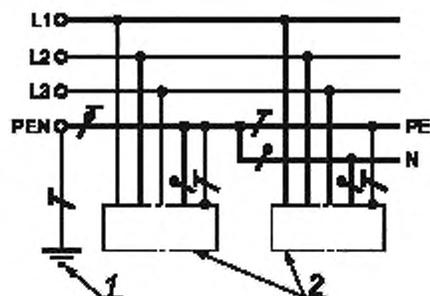
1 – заземление источника питания; 2 – открытые проводящие части
