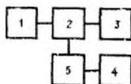
1 — проверяемый радиопередатчик; 2 — устройство связи; 3 — эквивалентное нагрузочное сопротивление (эквивалент антенны); 4 — электронно-счетный частотомер; 5 — аттенуатор
