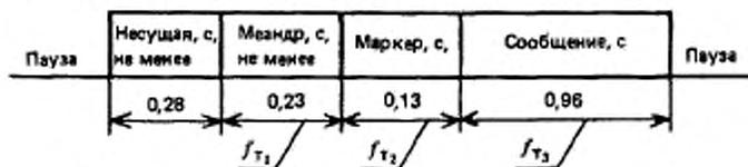
$f_{T1}$  — тактовая частота, равная 50 Гц;  $f_{T2} = f_{T3}$  — тактовая частота, равная 100 Гц
