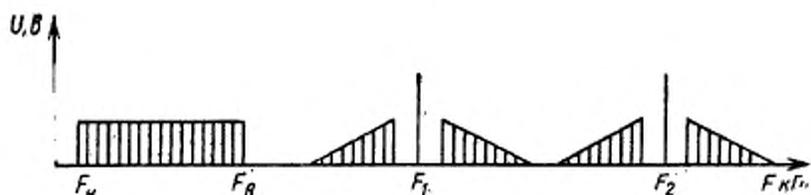
$F_{н}$ ,  $F_{в}$  — нижняя и верхняя частоты спектра основного сигнала звукового сопровождения;  $F_1$ ,  $F_2$  — центральные частоты спектров частотно-модулированных поднесущих
