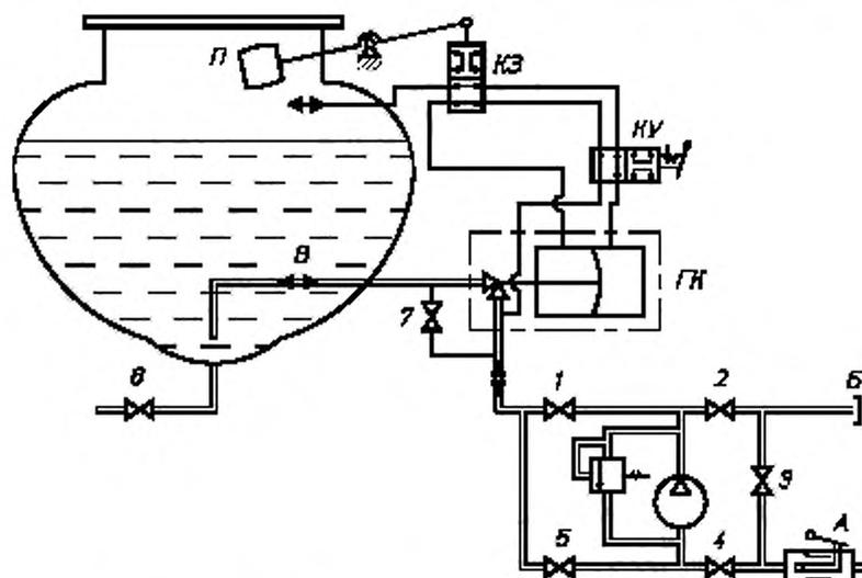
1–6 – задвижки; 7 – вентиль; А – напорно-всасывающий патрубок; Б – vaporный патрубок; В – трубопровод для наполнения и опорожнения; ГК – гидроклапан; П – поплавок; КЗ – кран золотниковый; КУ – кран управления
