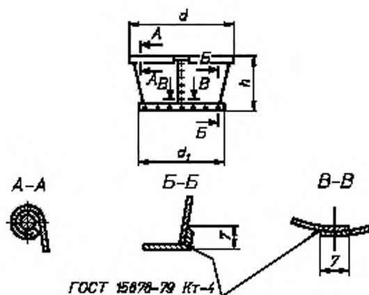
Рисунок 4 – Формы многослойные сварные
