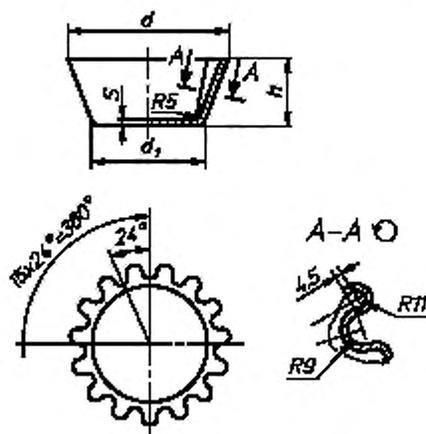
Предельное отклонение угла между осью двух кривых гофра  $\pm 1^\circ$
