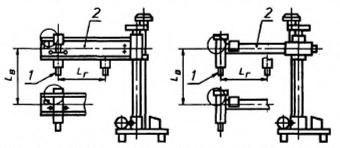
I — сварочный автомат; 2 — консоль;  $L_{\rm f}$  — горизонтальный ход консоли или сварочного автомата вдоль оси консоли;  $L_{\rm h}$  — вертикальный ход консоли
