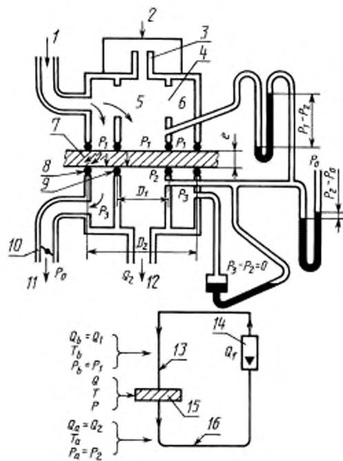
$D_1$  – средний диаметр внутренних уплотнителей;  $D_2$  – диаметр головки;  $Q$  – объемная скорость потока при давлении  $P_2$ ;  $P_0$  – атмосферное давление;  $P_3$  – давление на выходе из образца после просачивания между уплотнительными кольцами, его устанавливают равным  $P_2$ ;  $P_2 - P_1$  – перепад давления на расходомере;  $P_1 - P_2$  – перепад давления на пористом металле
