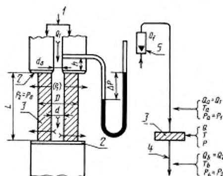
Примечание — Чтобы свести к минимуму поправку на прибор, расстояние  $h$  должно быть как можно меньшим, а диаметр  $d_0$  должен быть приблизительно равен диаметру  $d$ .
