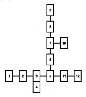
1 – латер, 2, 6 – днафрагма; 3 — элемент; 4 — столик; 5 — средство юстировки; 7 — приемник; 8, 11 — ослабитель энергии (мощности); 9 — делительная пластина; 16 — регистрирующее устройство; 12 — средство измерений энергии (кошности) дазерного и изучения (измерятель)
