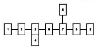
I – лазер; 2, 8 – двафрагма; 3 – элемент; 4 – столик; 5 – ослабитель; 6 – регистрярующее устройство; 7 – приемник; 9 – средство юстировки (юстировочный лазер)
