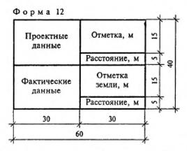
При размещении на листе двух поперечных профилей и более боковик тиолицы допускается выполнять только у первого поперечного профиля.
