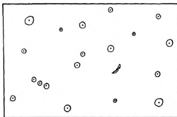
Рисунок А.6 — Форма и расположение отметок — класс E
