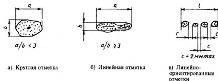
Рисунок А.1 — Типы отметок
