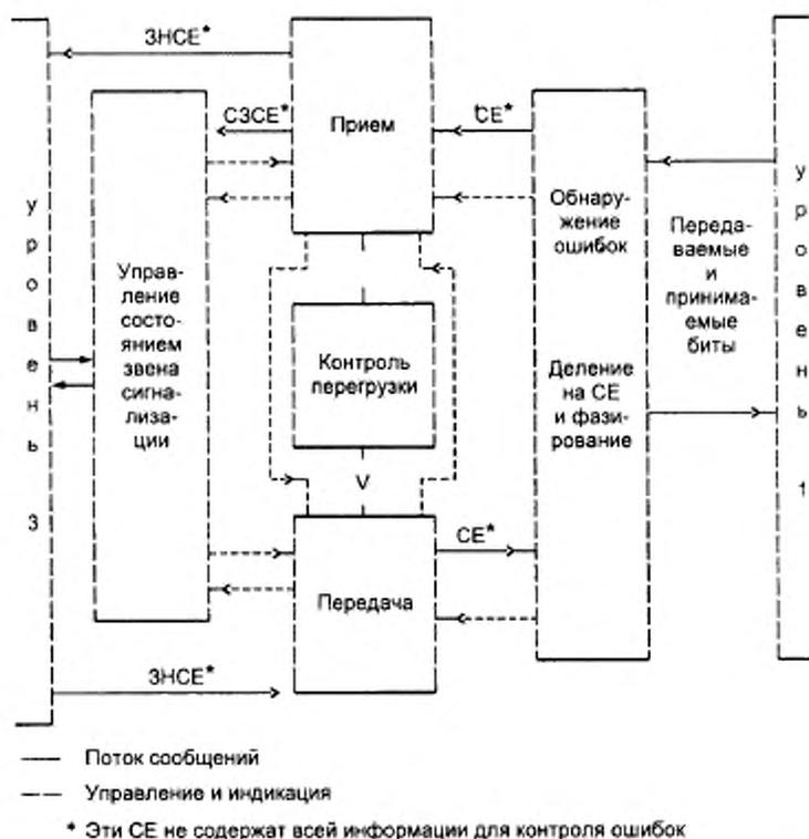
Рисунок 8.1 — Функциональная схема взаимодействия блоков звена сигнализации
