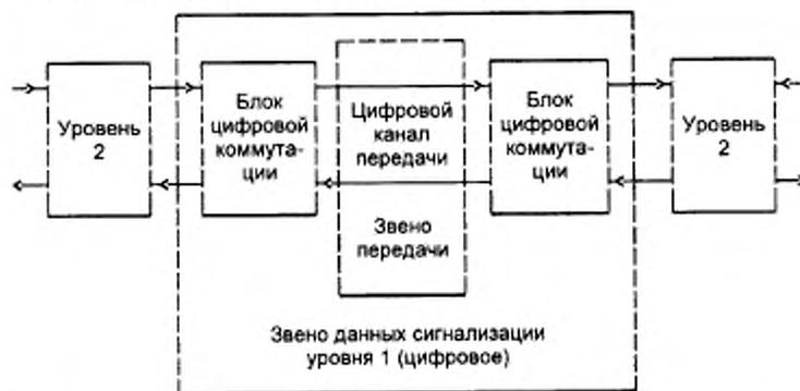
Рисунок 7.1 — Функциональная конфигурация звена данных сигнализации
