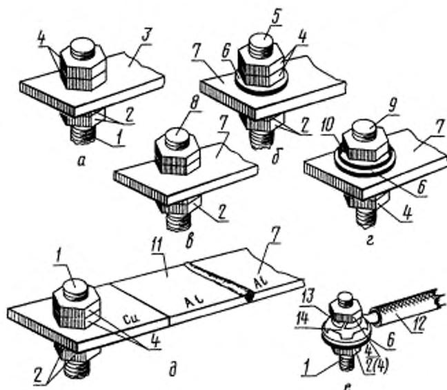
*a* — проводник из меди, твердого алюминиевого сплава или алюминия с защитным металлическим покрытием рабочей поверхности; *b*, *c*, *e* — алюминиевый проводник; *d* — алюминиевый проводник через переходную медно-алюминиевую пластину; *e* — однопроволочная (многопроволочная) жила провода кабеля сеч.  $10 \text{ мм}^2$  с изгибанием в кольцо
