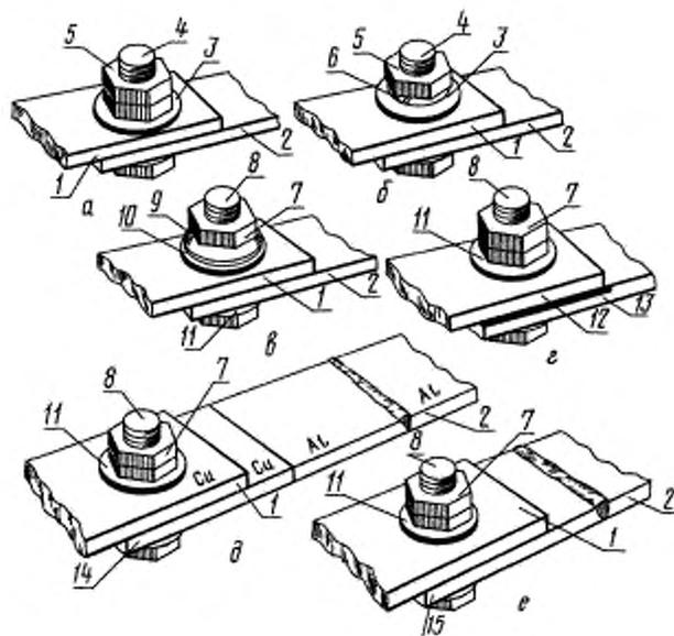
*a* — крепежом из цветного металла с контргайкой; *b* — крепежом из цветного металла с пружинной шайбой; *e* — стальным крепежом с тарельчатой пружинной; *z* — стальным крепежом с защитными металлическими покрытиями рабочих поверхностей с контргайкой (пружинной шайбой); *d* — стальным крепежом через переходную медно-алюминиевую пластину с контргайкой (пружинной шайбой); *e* — стальным крепежом через переходную пластину из твердого алюминиевого сплава с контргайкой (пружинной шайбой)
