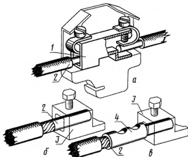
*а, б* — однопроволочная (многопроволочная, сплавленная в монолит) жила; *а* — многопроволочная жила, оконцованная кабельным наконечником
