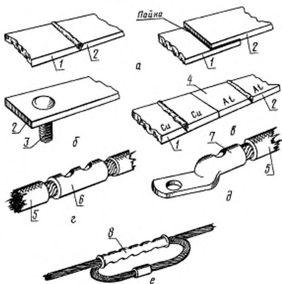
*a* — сваркой или пайкой; *б* — со штыревым выводом сваркой; *в* — сваркой через переходную медно-алюминиевую пластину; *г* — соединение жил проводов (кабелей) через соединительную гильзу опрессовкой; *д* — соединение жилы провода (кабеля) с кабельным наконечником опрессовкой (сваркой, пайкой); *е* — соединение жил проводов в овальных соединителях
