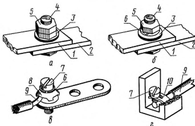
*a* — с контргайкой; *б* — с пружинной шайбой; *в* — однопроводочная (многопроводочная) жила провода (кабеля) сеч. до 10 мм<sup>2</sup> с изгибанием в кольцо; *г* — однопроводочная (многопроводочная) жила провода (кабеля) сеч. до 10 мм<sup>2</sup> без изгибания в кольцо
