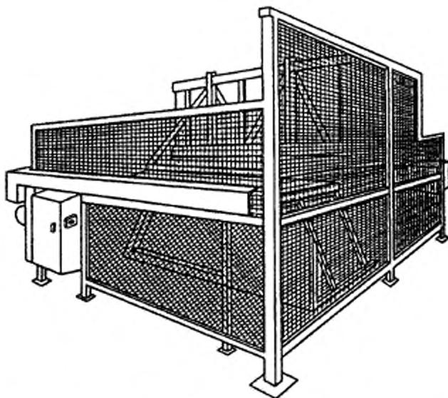
Рисунок 2 — Пример съемного дистанционного защитного устройства
