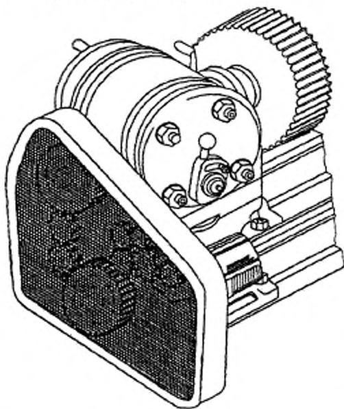
Рисунок 1 — Пример оболочки, которая препятствует доступу к передаче
