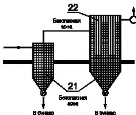
Рисунок А.4 — Циклон и фильтр: чистое выходное отверстие вне строения
