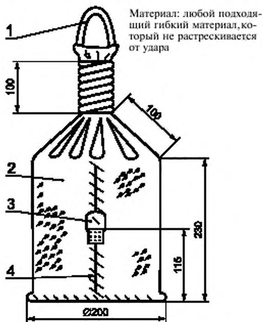
1 — петля; 2 — песок с размером частиц от 0,5 до 0,8 мм; 3 — ушко, используемое для подъема мешочка и последующего его опускания; 4 — шов (только со стороны ушка, ударная сторона без шва)
