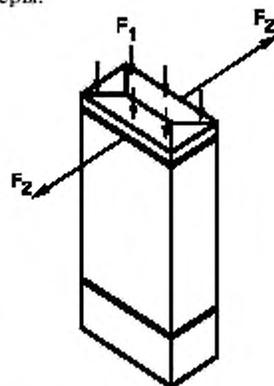
$F_1$  — равномерно распределенная нагрузка 8500 Н/м<sup>2</sup>,
