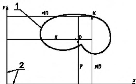
1 — траектория движения вала; 2 — координатные оси; 0 — среднее положение вала; K — мгновенное положение центра вала; x, y — средние значения перемещения вала;  $x(t)$ ,  $y(t)$  — мгновенные значения перемещения вала
