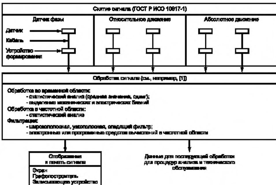
Рисунок 1 — Структура системы измерений вибрации вала
