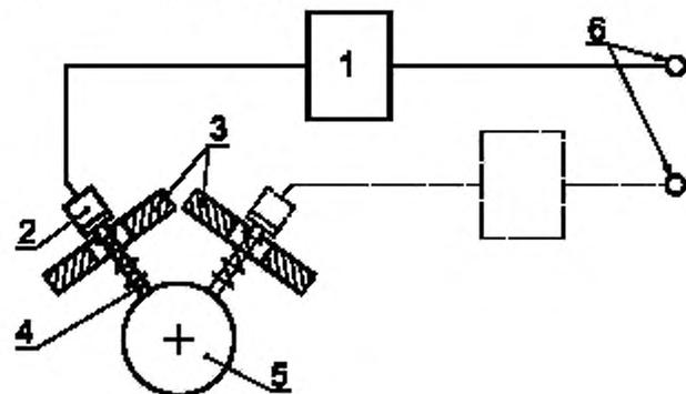
1 — устройство согласования; 2 — датчик инерционного типа; 3 — элементы конструкции машины; 4 — зонд; 5 — вал; 6 — выходные сигналы
