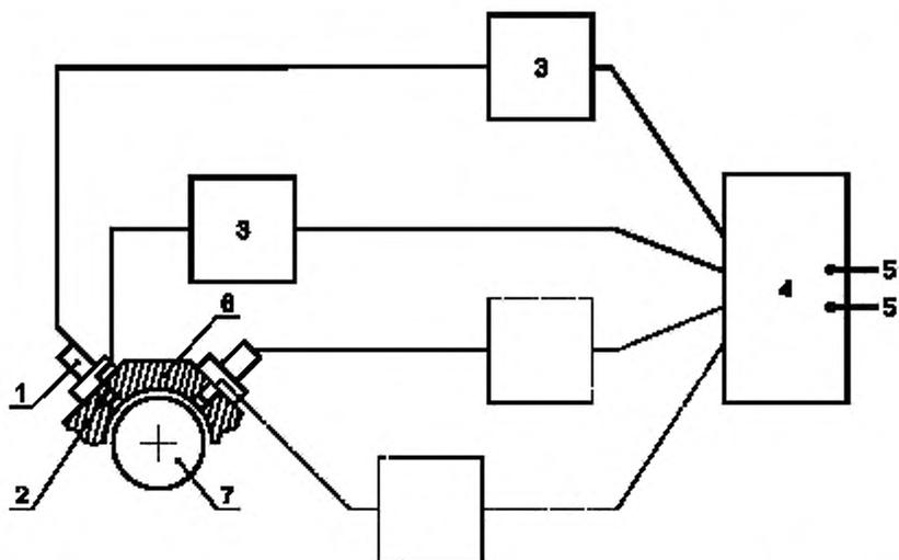
1 – датчик инерционного типа; 2 – датчик бесконтактного типа; 3 – устройство согласования; 4 – считывающее устройство;
