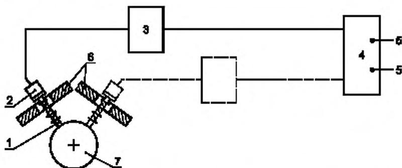
1 – датчик-зонд; 2 – датчик инерционного типа; 3 – устройство согласования; 4 – считывающее устройство;
