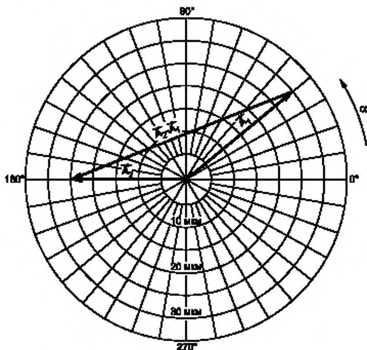
исходный вектор —  $|\vec{A}_1| = 30$  мкм,  $\alpha = 40^\circ$ ; вектор после изменений —  $|\vec{A}_2| = 25$  мкм,  $\alpha = 180^\circ$  изменение амплитуды вибрации —  $|\vec{A}_2| - |\vec{A}_1| = -5$  мкм; амплитуда вектора изменения вибрации —  $|\vec{A}_2 - \vec{A}_1| = 52$  мкм
