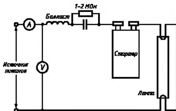
Рисунок 7 — Схема испытания стартеров на зажигание
