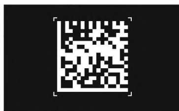
b) Data Matrix — светлое изображение на темном фоне (изображение с обратными значениями коэффициентов отражения)
