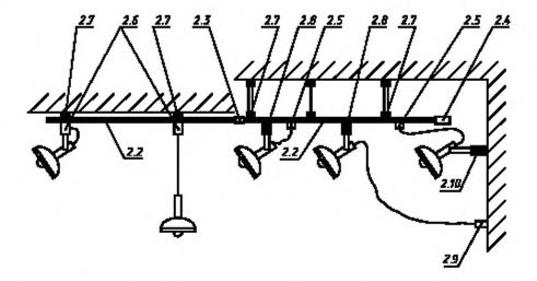
2.2 — секция шинопровода; 2.3 — соединитель; 2.4 — вводное устройство (может включать трансформатор); 2.5 — штепсель (питание только от секция шинопровода); 2.6 — вдантер для механического и электрического присоединения светильника к шинопроводу; 2.7 — подвес шинопровода (к потолку, к подвеске из труб или вроволоки); 2.8 — подвес светильника; 2.9 — независимая коробка с розеткой; 2.10 — механическое закрепление светильника к стене:
