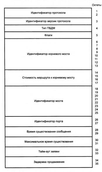
Рисунок 5.1 — Параметры и формат ПБДМ «конфигурация»
