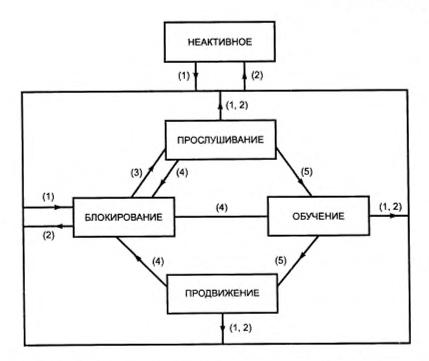
I — порт активизирован диспетчером или после инициализации; 2 — порт деактивизирован диспетчером или вышел из строя; 3 — алгоритм выбрал данный порт назначенным или портом корневого моста; 4 — алгоритм не выбрал данный порт назначенным или портом корневого моста; 5 — истек протокольный тайм-аут (тайм-аут продвижения)
