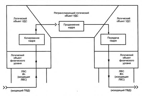
Рисунок С.2 — Элементы мостовой функции маршрутизации со стороны отправителя
