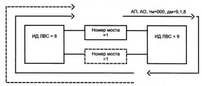
Обозначения: АП — адрес получателя; ТМ — поле типа маршрутизации; АО — адрес отправителя; ДМ — дескриптор маршрута.
