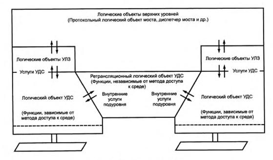
Рисунок 3.3 — Архитектура моста
