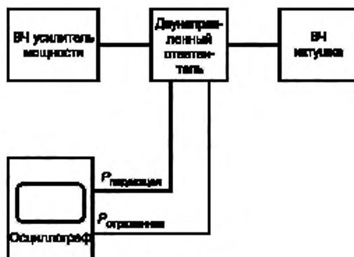
Примечание — На схеме не приведены согласующие нагрузки на входе осциллографа.
