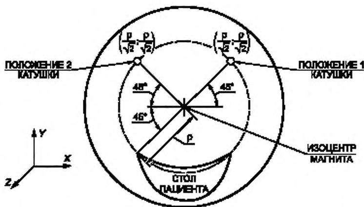
Рисунок 103 — Положения измерительной катушки при измерениях  $\frac{dB}{dt}$
