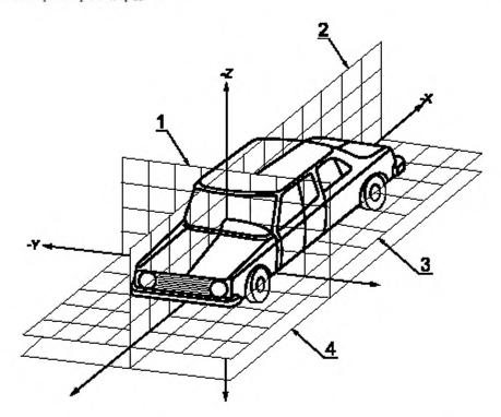
I — исходная плоскость X (вертикальная поперечная исходная плоскость); 2 — исходная плоскость Y (вертикальная про-дольная исходная плоскость); 4 — опорная поскость); 4 — опорная поскость
