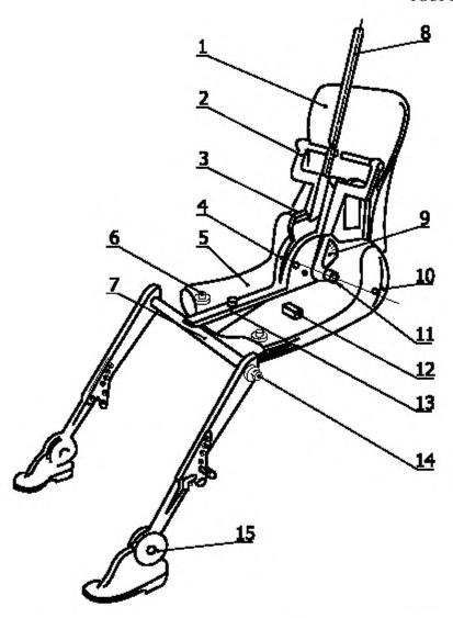
1 — спинка; 2 — кронштейн спинных грузов; 3 — уровень угла наклона спинки; 4 — круговой сектор явклона бедра; 5 — основание; 6 — кронштейн набедренных грузов; 7 — коленный шарнир Т; 8 — штырь; 9 — круговой сектор наклона спинки; 10 — визирные метки точки В; 11 — ось вращения точки В; 12 — поперечный уровень; 13 — кронштейн бедра; 14 — круговой сектор сгиба колена, 15 — круговой сектор сгиба ступни
