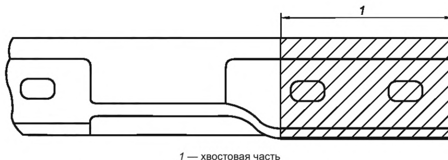
Рисунок 3.13 — Хвостовая часть литого сердечника сборной крестовины
