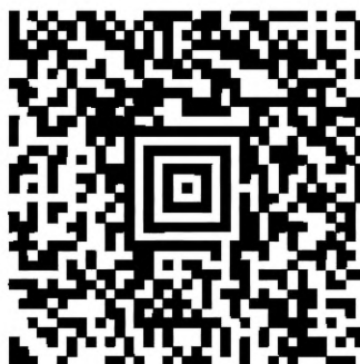
Рисунок А.5 — Символ Aztec Code с параметром «повреждение фиксированных шаблонов»
