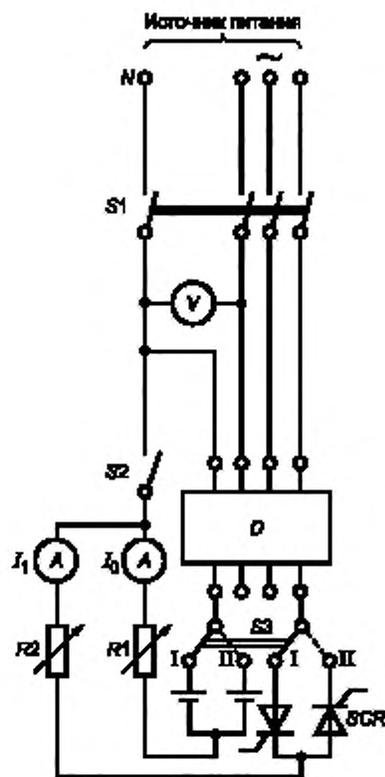
*D* — испытуемый АВДТ; *V* — вольтметр; *A* — амперметр (измерение действующего значения); *R1*, *R2* — регулируемые резисторы; *S1* — многополюсный выключатель; *S2* — однополюсный выключатель; *S3* — выключатель на два направления; *SCR* — тиристоры
