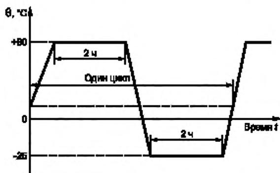
Рисунок F.8 — Цикл испытаний на тепловой удар
