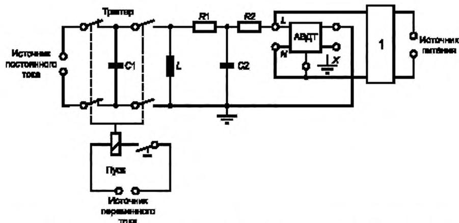
$I$  — фильтр;  $L = 5$  мкГн;  $R1 = R2 = 25$  Ом;  $C1 = 0,5$  мкФ;  $C2 = 5$  нФ;  $X$  — зажим заземления, если имеется, подсоединенный к нейтральному зажиму, если он маркирован, или, в отсутствие такой маркировки, к любому фазовому зажиму
