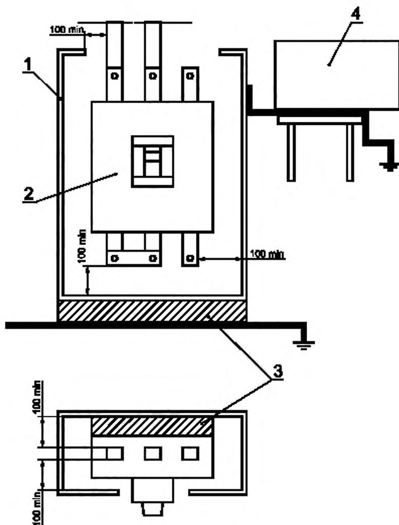
1 — металлическая оболочка; 2 — выключатель; 3 — металлическое основание,
