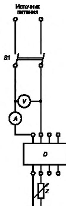
*A* — амперметр; *V* — вольтметр;
