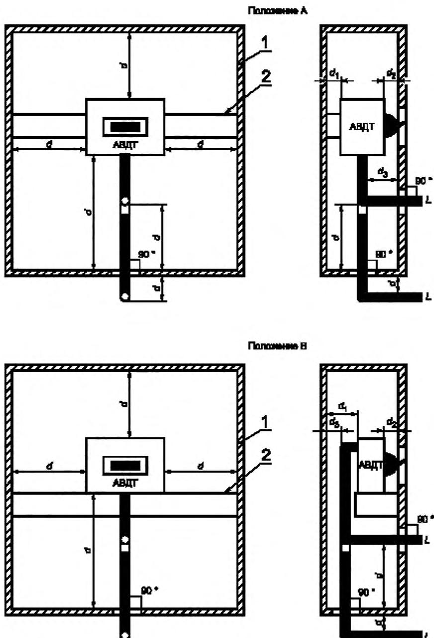
*1* — металлическая оболочка, *2* — металлическая панель;  $L \leq 1$  м — максимальная длина кабеля между АВДТ и соединительным устройством;  $d$  — любой размер, но не менее 0,1 м;  $d_1$ ,  $d_2$  — согласно конструкции изготовителя;  $d_3$  — максимальное расстояние, допускаемое конструкцией
