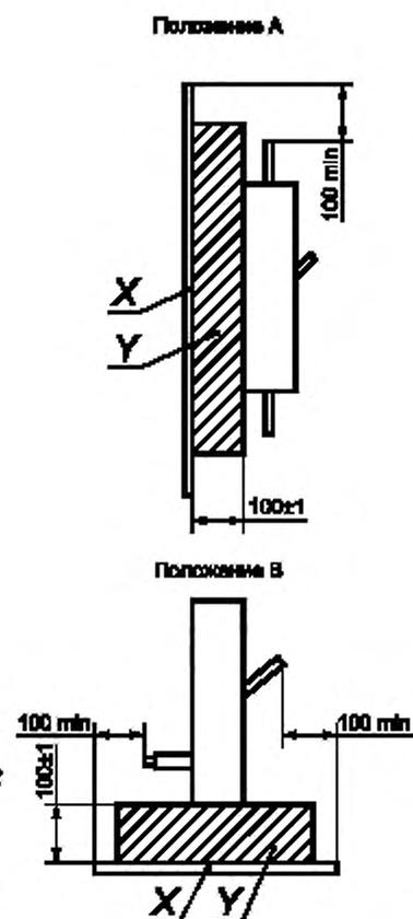
*X* — экранирующая контрольная плоскость согласно ГОСТ Р 51317.4.4; *Y* — изоляционная панель
