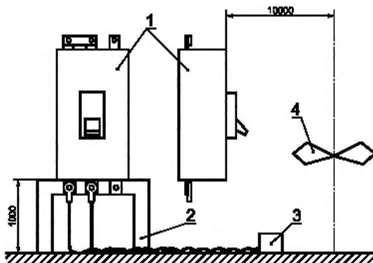
1 — испытуемый выключатель; 2 — изолирующая опора; 3 — источник питания;
