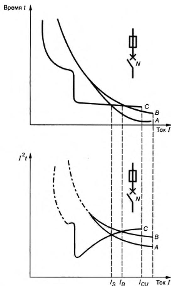
$I$  — ожидаемый ток короткого замыкания;  $I_{CU}$  — номинальная предельная наибольшая отключающая способность (4.3.5.2.1);  $I_s$  — предельный ток селективности (2.17.4);  $I_B$  — ток координации (2.17.6);  $A$  — предугонная характеристика плавкого предохранителя;  $B$  — рабочая характеристика плавкого предохранителя;  $C$  — рабочая характеристика литокоординирующего выключателя ( $N$ ) (время отключения/ток и  $I^2t$ /ток)
