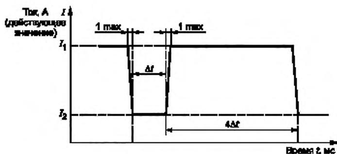
$I_1$  — ток уставки;  $I_2$  — испытательный ток провала;  $\Delta t$  — время провала
