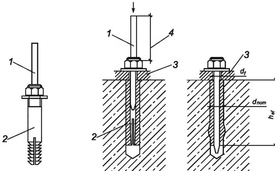
1 — распорный стержень; 2 — втулка; 3 — опорная пластина; 4 — контролируемое перемещение
