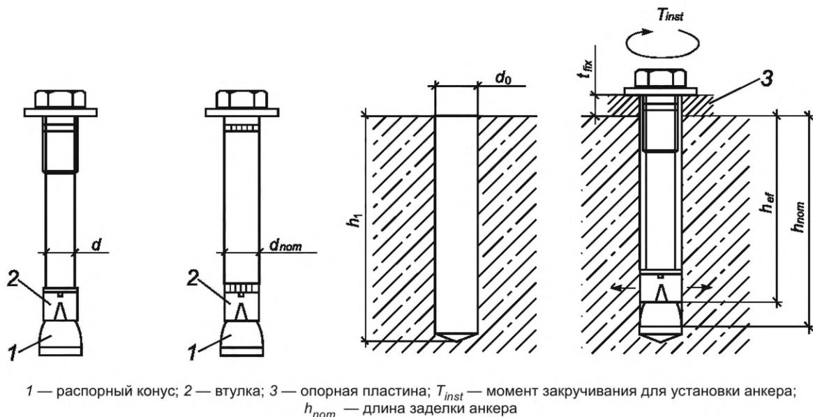
Рисунок 1 — Распорные анкеры с контролем момента затяжки
