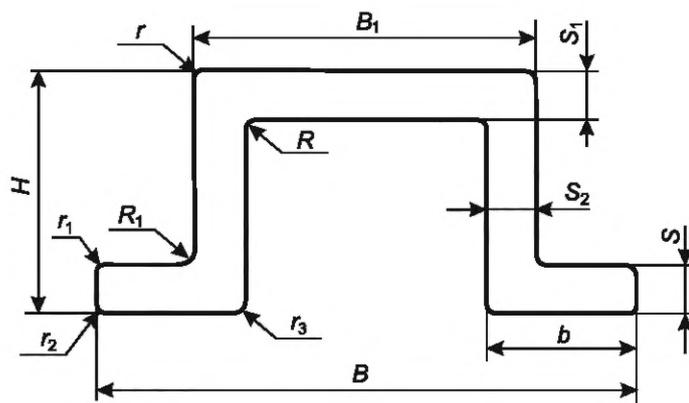
$B, B_1$  — длина;  $b$  — длина полки;  $H$  — высота;  $S, S_1, S_2$  — толщина;  $R, R_1$  — радиусы скругления;  $r, r_1, r_2, r_3$  — радиусы притупления
