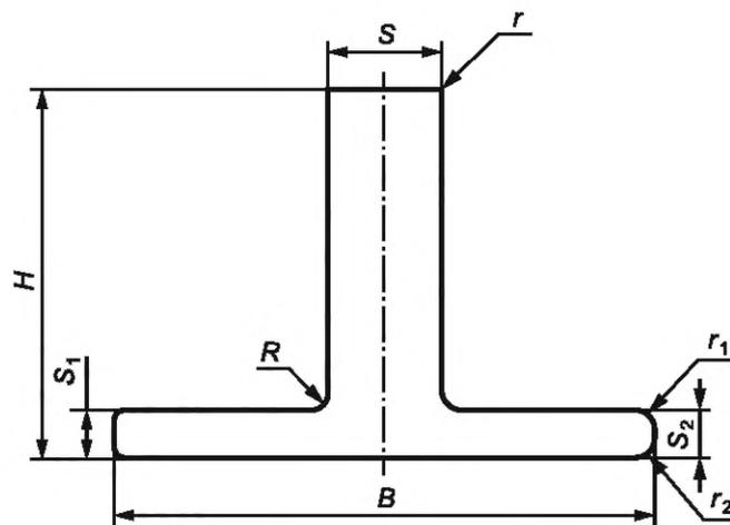
$B$  — длина;  $H$  — высота;  $S$ ,  $S_1$ ,  $S_2$  — толщина;  $r$ ,  $r_1$ ,  $r_2$  — радиусы притупления;  $R$  — радиус скругления
