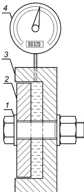
1 — болтокомплект; 2 — поршень; 3 — корпус; 4 — манометр или индикатор усилия
