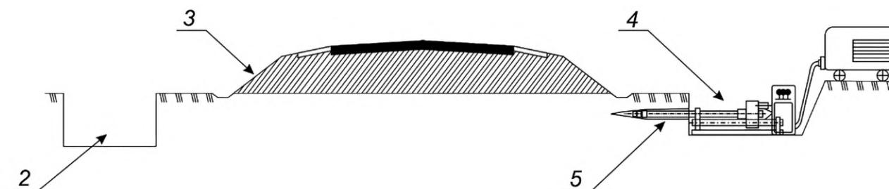
б) Пересечение автомобильной дороги методом прокола
