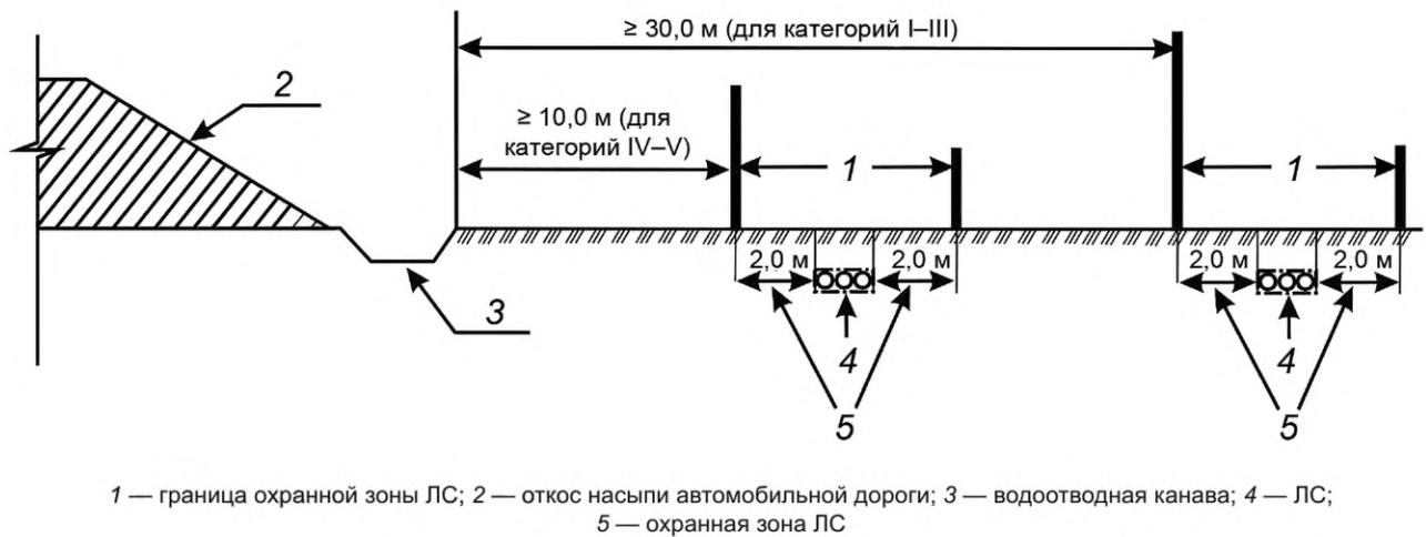
Рисунок 1 — Расстояния от охранных зон ТЛС до элементов автомобильных дорог
