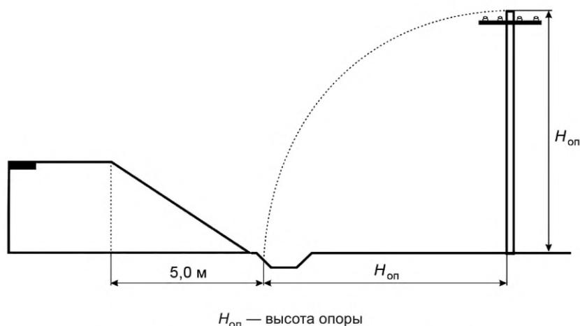
Рисунок 5 — Размещение опор ЛС вдоль автомобильных дорог
