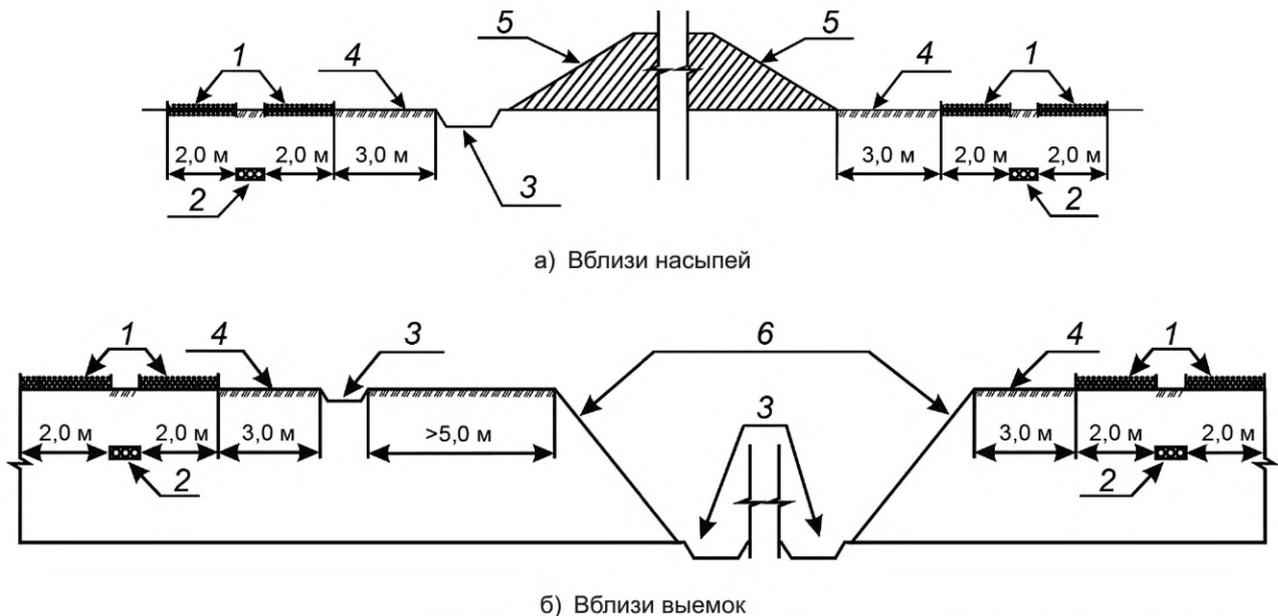
Рисунок 2 — Минимальные расстояния от элементов автомобильных дорог до внешних границ охранных зон ТЛС
