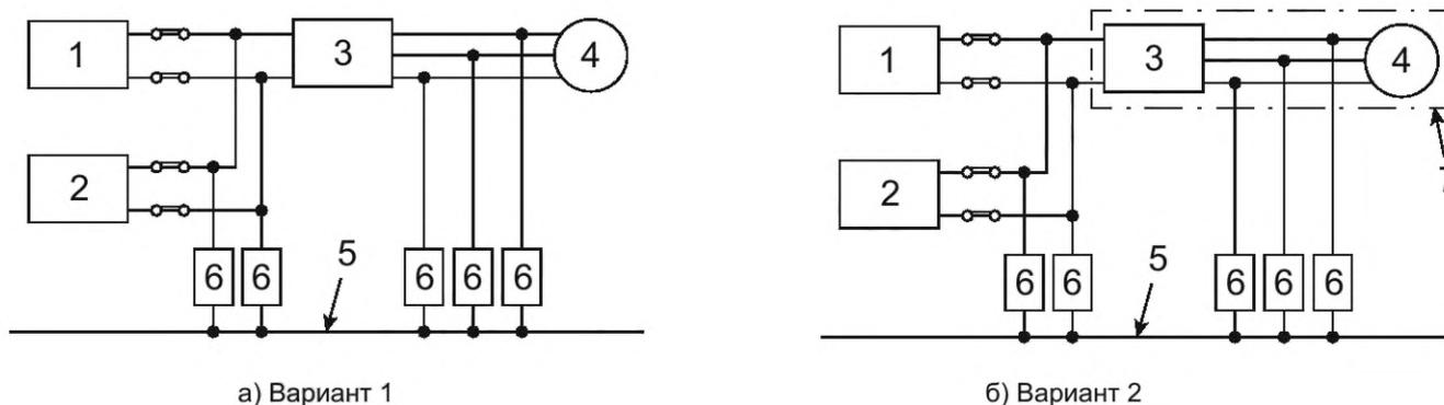
1 — система топливных элементов; 2 — ПСХЭЭ; 3 — инвертор; 4 — двигатель; 5 — электрическое шасси ЭТС; 6 — отдельные сопротивления изоляции; 7 — дополнительные защитные меры для цепи переменного тока
