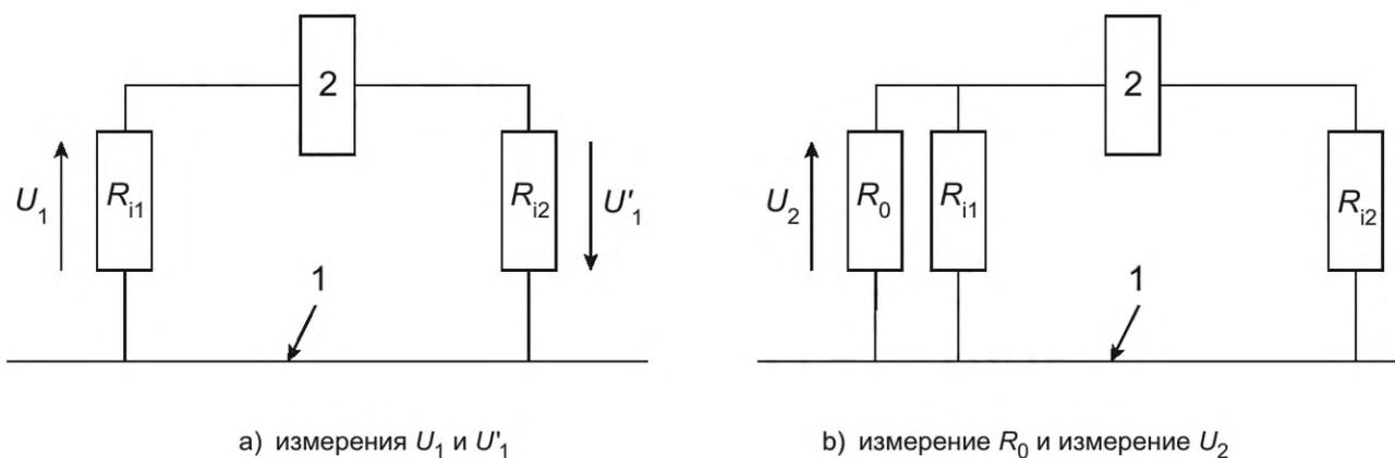
1 — электрическое шасси; 2 — источник электрической энергии
