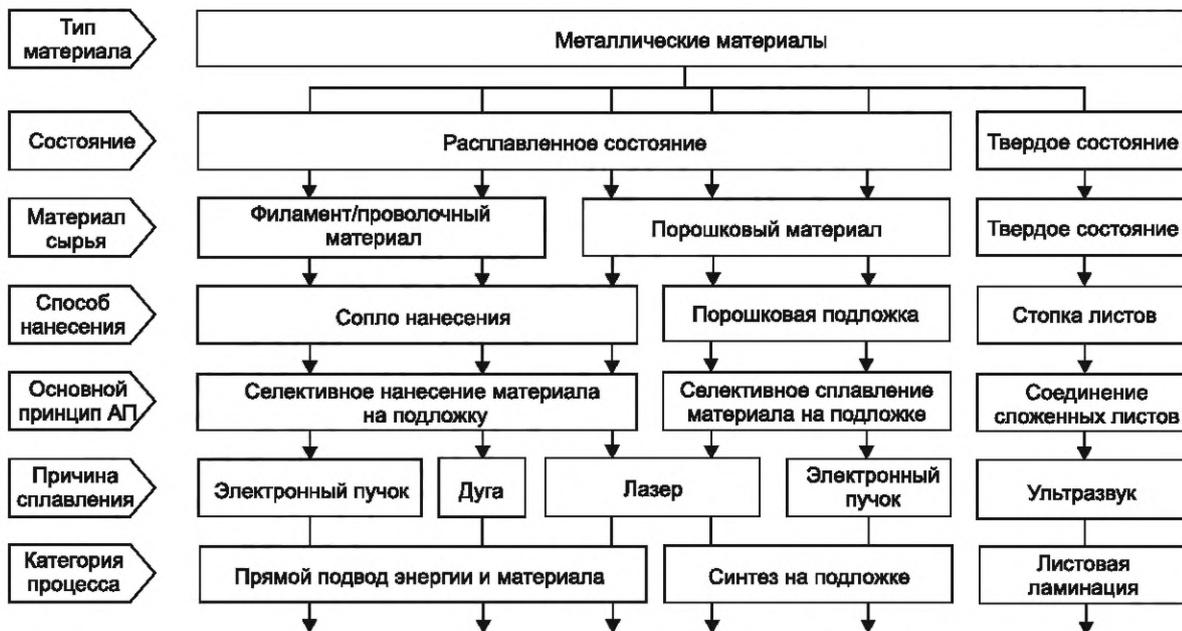
Рисунок В.2 — Обзор одношаговых аддитивных технологических процессов для металлических материалов
