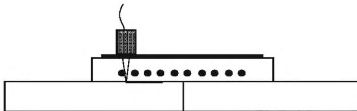
Рисунок 3 — Контроль прямым преобразователем продольными волнами
