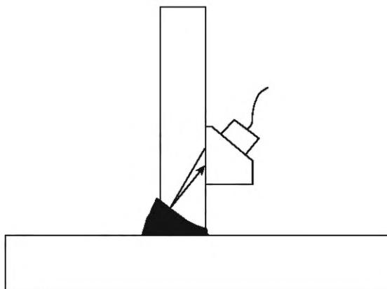
Рисунок 4 — Контроль с наклонным вводом продольных волн
