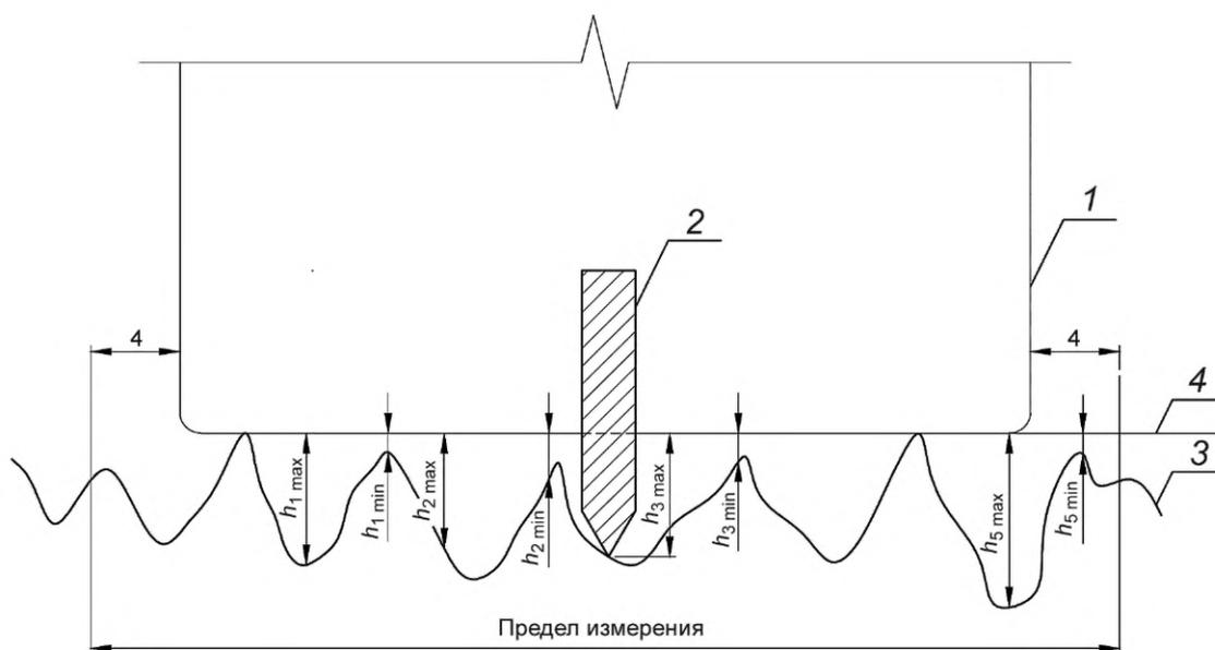
1 — датчик профилометра; 2 — щуп; 3 — профиль исследуемой поверхности; 4 — линия выступов профиля
