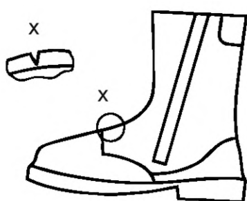
а) Глубокие трещины в верхе
