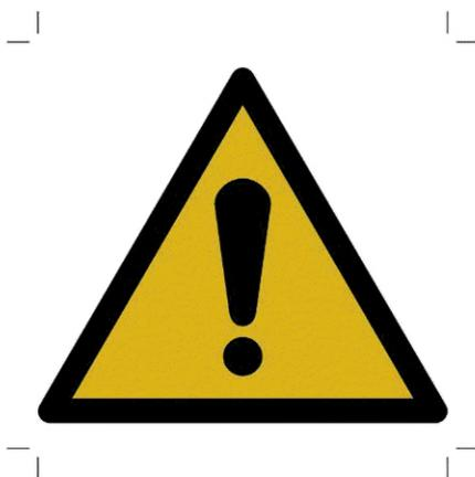
Рисунок В.1 — Общий предупреждающий знак. ISO 7010-W001
