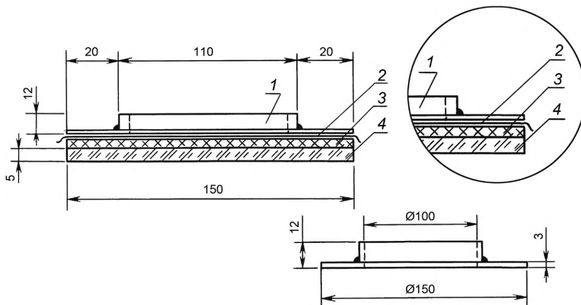
1 — металлическое кольцо с раствором; 2 — слой марлевой ткани; 3 — 10 слоев фильтровальной бумаги; 4 — стеклянная пластина
