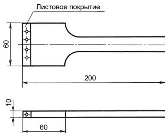
Рисунок 4 — Шпатель для уплотнения растворной смеси в форме
