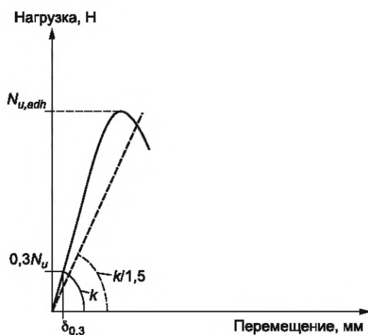
в) Оценка нагрузки при потере сцепления при стабильной жесткости
