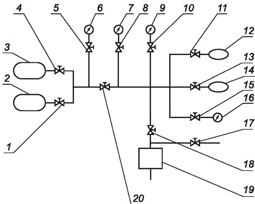
1, 4, 5, 8, 10, 11, 13, 15, 17, 18, 20 — вентили; 2, 3 — баллоны с компонентами газовой смеси; 6, 7, 9 — манометры;
