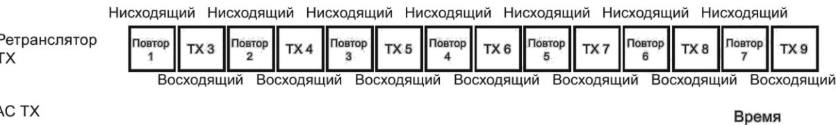
Рисунок 24 — Временные параметры одночастотного ретранслятора
