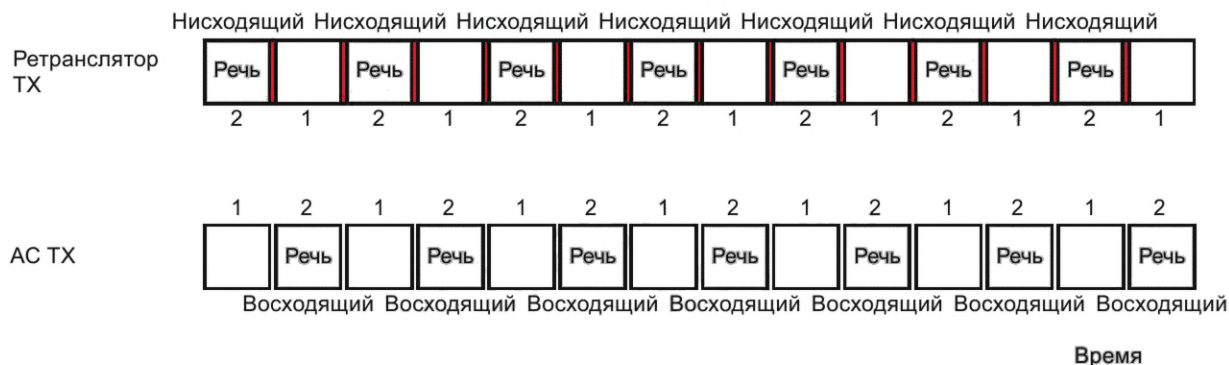
Рисунок 25 — Временные параметры речи TDD
