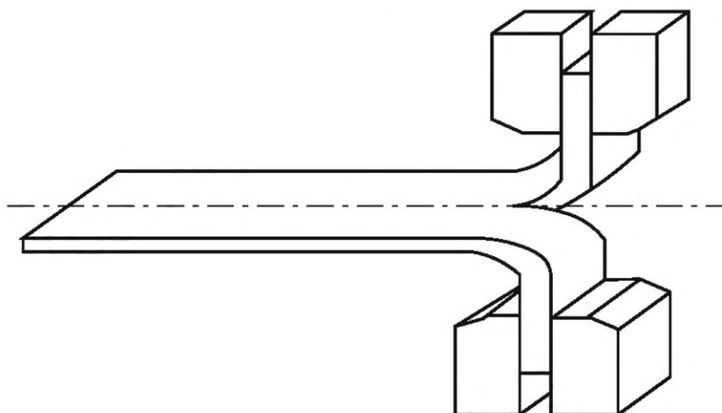
Рисунок 3 — Расположение надрезанного в форме брुक испытуемого образца на машине для испытания на растяжение
