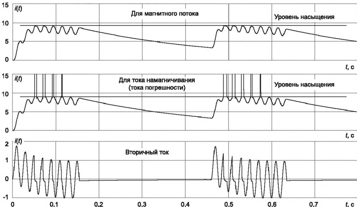
Рисунок В.4 — Работа ТТ при наличии насыщения
