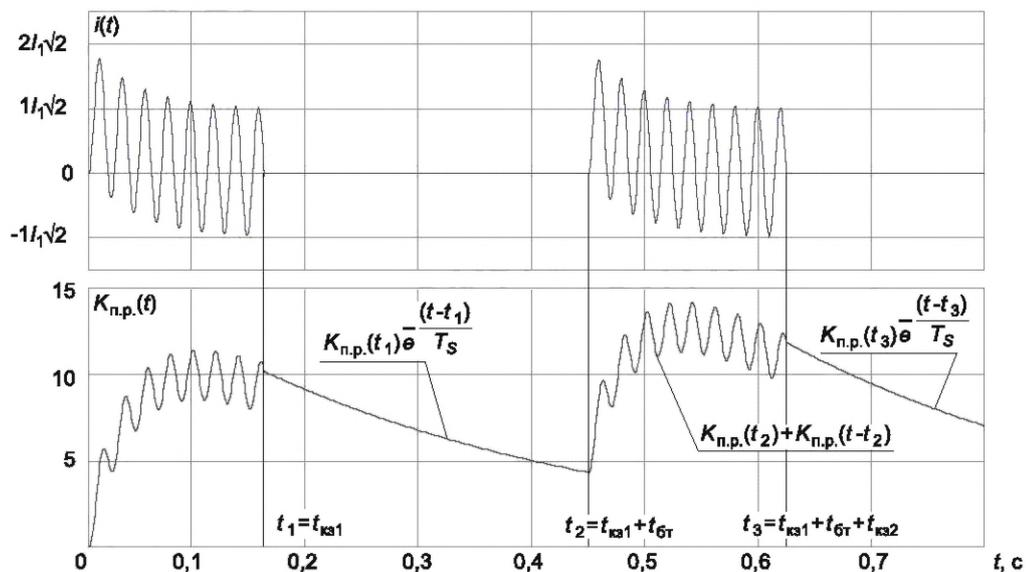
Рисунок В.3 — Работа ТТ в цикле АПВ
