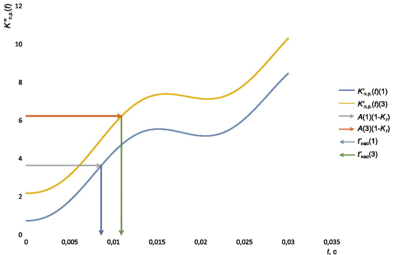
Рисунок Б.2 — Определение времени до насыщения ТТ при втором КЗ
