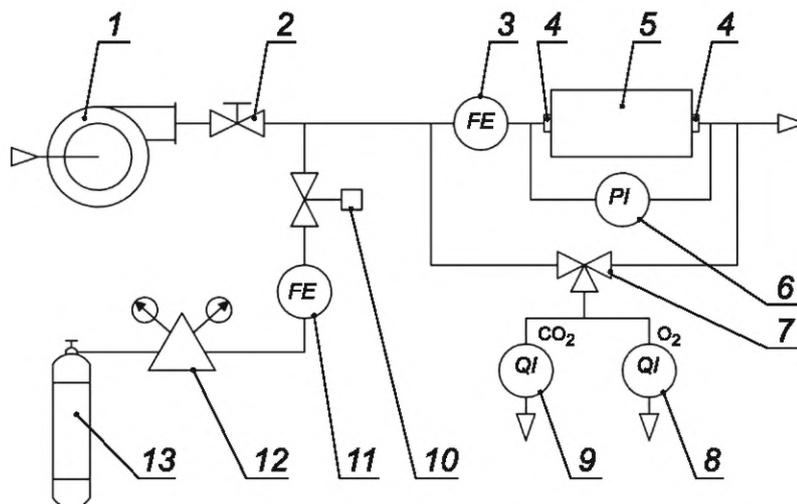
1 — побудитель расхода воздуха; 2 — затвор; 3, 11 — расходомеры (2 шт.); 4 — переходник (2 шт.); 5 — испытываемый регенеративный патрон; 6 — измеритель разности давлений; 7 — трехходовой кран; 8 — газоанализатор по кислороду; 9 — газоанализатор по диоксиду углерода; 10 — клапан; 12 — редуктор; 13 — баллон с диоксидом углерода
